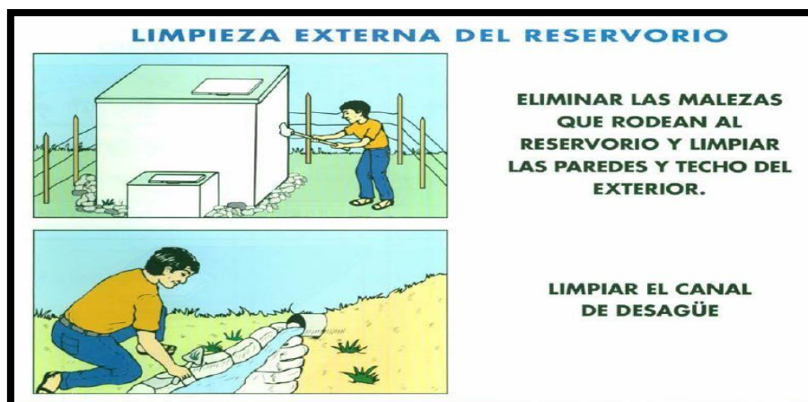
Ilustración 96 : LIMPIEZA DE RESERVORIOS
