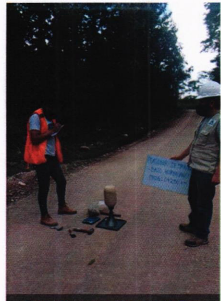
FOTO N°18. Prueba de densidad de campo en el sub tramo II: Progresiva 4+326 km.
