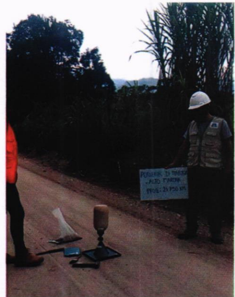
FOTO N°10. Prueba de densidad de campo en el sub tramo II: Progresiva 2+250 km.
