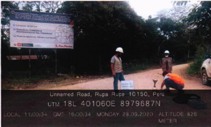
FOTO N°01. Prueba de densidad de campo en el sub tramo II: Progresiva 0+000 km.
