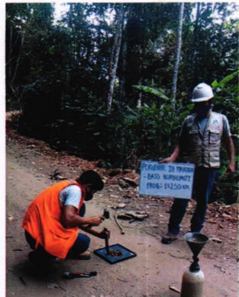
FOTO N°22. Prueba de densidad de campo en el sub tramo III: Progresiva 0+750 km.
