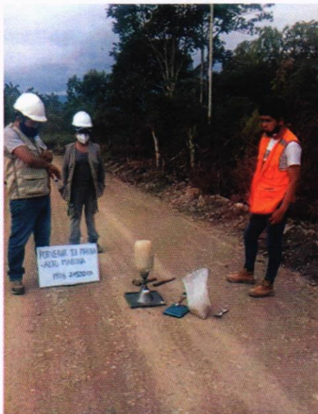
FOTO N°09. Prueba de densidad de campo en el sub tramo II: Progresiva 2+000 km.
