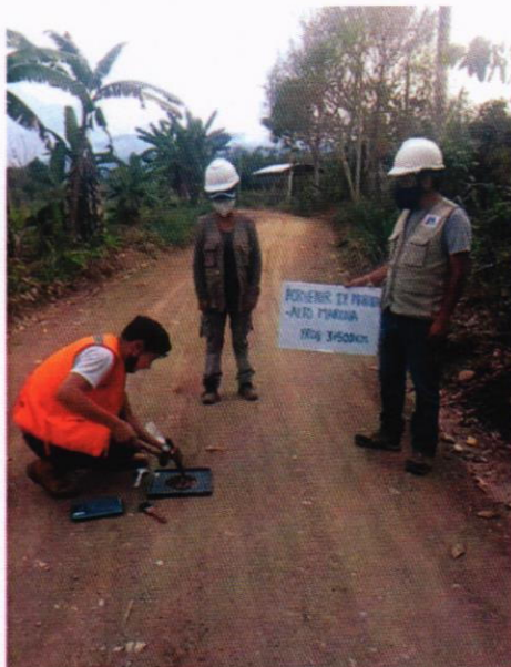
FOTO N°13. Prueba de densidad de campo en el sub tramo II: Progresiva 3+000 km.
