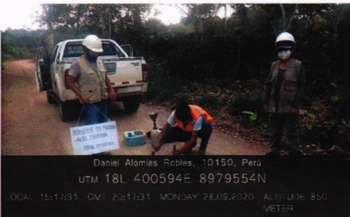
FOTO N°03. Prueba de densidad de campo en el sub tramo II: Progresiva 0+500 km.
