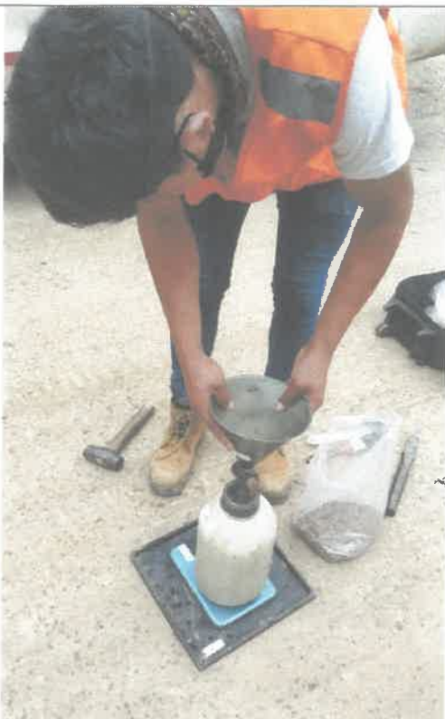
FOTO N°13. TRAMO I: 9+591 KM prueba de densidad de campo, coordenada (389228; 9001790) – 30/10/2020.
