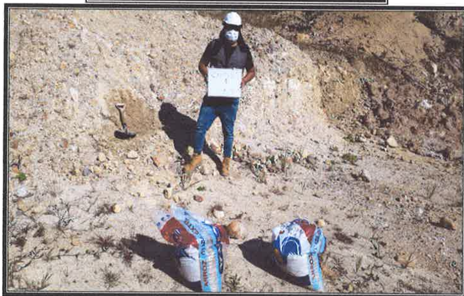
Vista fotográfica de la cantera Tramo I- en la ubicada en la prog. 05+495 al lado derecho con acceso directo, donde se aprecia la cantera conformada por grava limo arcillosa.
